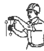
4 LEVANTAR EL AGUILÓN O PLUMA LENTAMENTE
