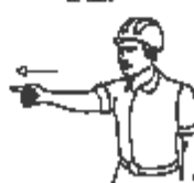
11 BAJAR EL AGUILÓN EN LA DIRECCIÓN INDICADA POR EL DEDO
